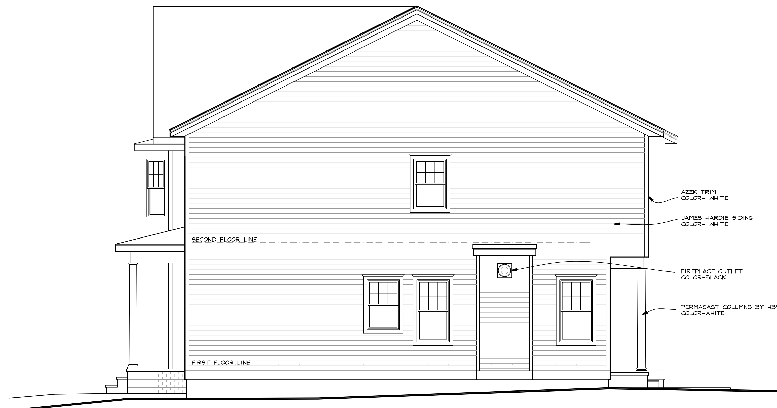
(D) EAST ELEVATION A3 1/4" = 1 FOOT
